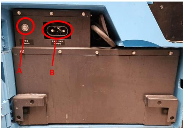
A - Botão Liga/Desliga (Máquinas que fiquem paradas e desligadas na chave de contato por mais de 50h, deverão ser reiniciadas neste botão. (Apenas um toque)
